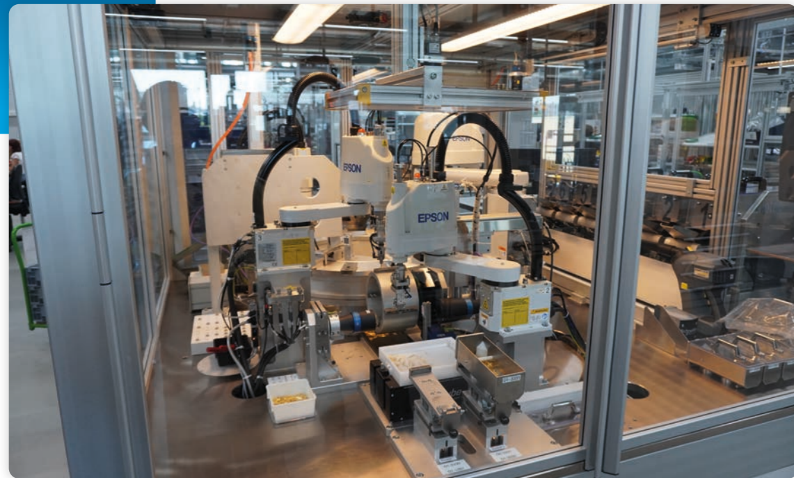
Eine der insgesamt sieben vollautomatischen Montagemaschinen im Segment Miniatur
